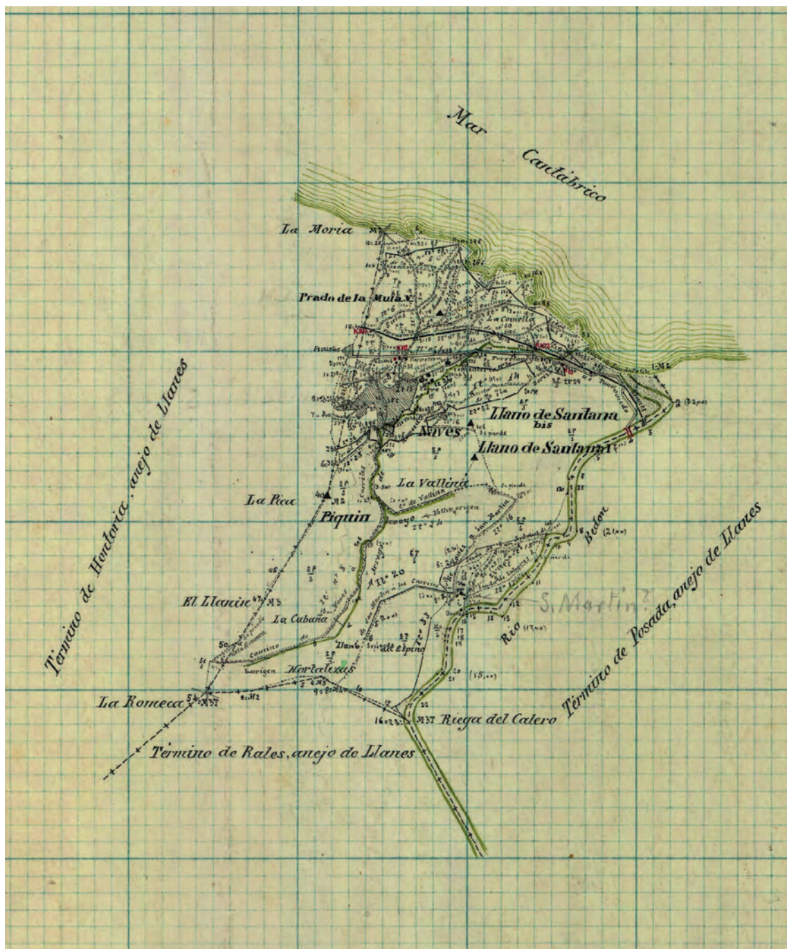
Representación del anejo planimétrico de Naves, con toda la información recogida en los trabajos de campo (1918) y anotación posterior (en rojo, 1941). Se recoge, entre otra información, la manzana de edificación que configura el núcleo, la red viaria con anotaciones referentes al tipo o destino de la misma, los cauces existentes, el amojonamiento realizado, la toponimia de distintos accidentes geográficos, los itinerarios realizados, los anejos que limitan con el que se reproduce, etc.
