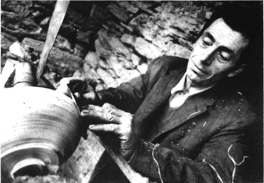
8) Con el lijado termina el trabajo en el torno.
